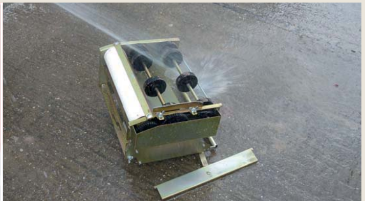
7.3.8 Po ukončení práce maltovací vozík důkladně vyčistěte proudem vody.
