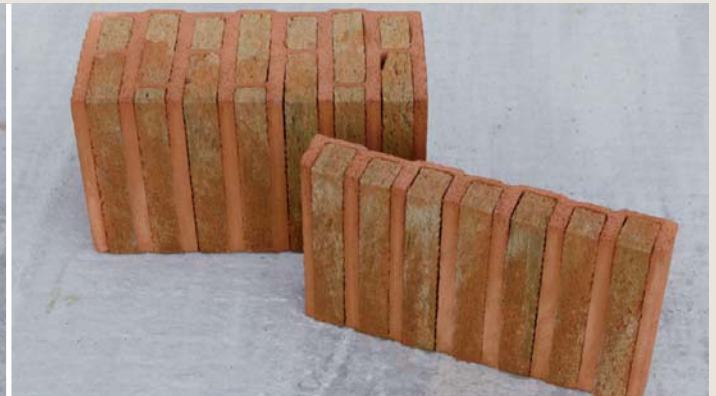
7.8.4 Rovně uříznutá cihla pro vyrovnání délky stěny.
