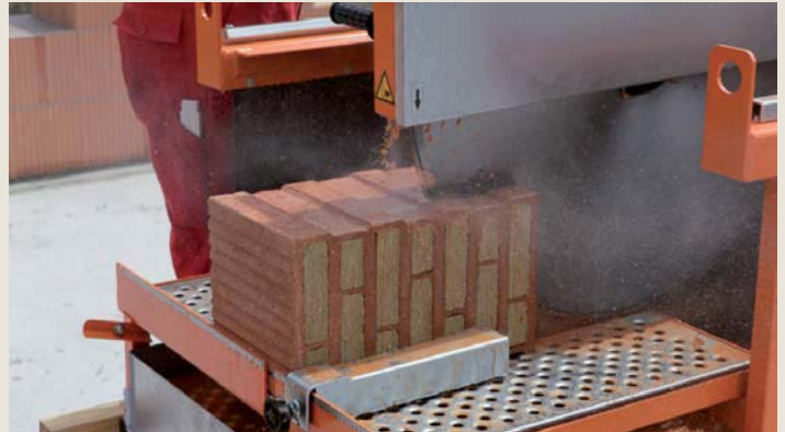
7.8.1 Pilou pro mokré řezání je možné řezat vyrovnávací cihly na libovolnou výšku.
