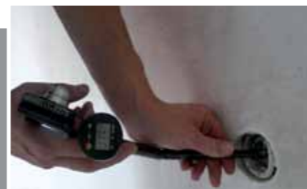
řádně zasádrovaná elektroinstalační krabice je vzduchotěsná
